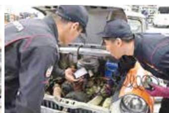
エンジン内部をカメラで撮影し、状態を細かく確認します。
