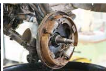
分解したブレーキ。各パーツを外して清掃し、交換が必要なパーツを手配します。
