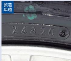
タイヤのサイドには製造年週が明記されていて、4桁のうち、後ろ2桁が製造年末尾2桁。前2桁が何週目を表わしています。
